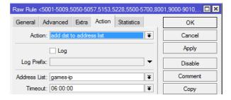
Gambar 13. Pengaturan tab action pada filter raw
